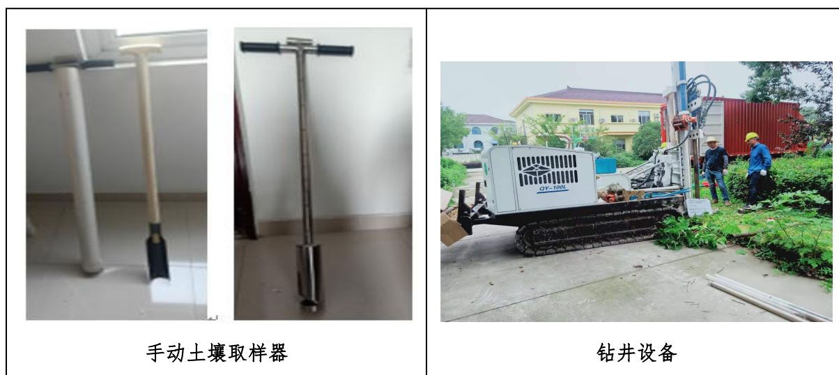
图 5-1 土壤样品与地下水钻孔设备
